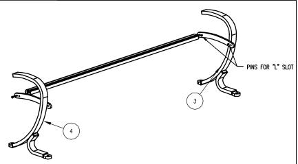
(2) INSERT SEAT/BACK INTO STEP 1, USING SLOT ON ALUM. EXTRUSION.
