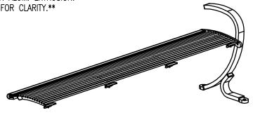
(3) ATTACH REMAINING ALUM. EXTRUSION TO SUPPORTS, AS IN STEP 1.
