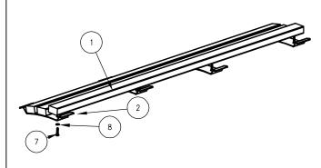
2 ATTACH 2 ALUM. EXTRUSIONS AS SHOWN, TO LEFT & RIGHT BENCH SUPPORTS, ENSURE
